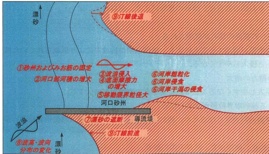
図 4-1-1 河口導流堤の設置イメージ
