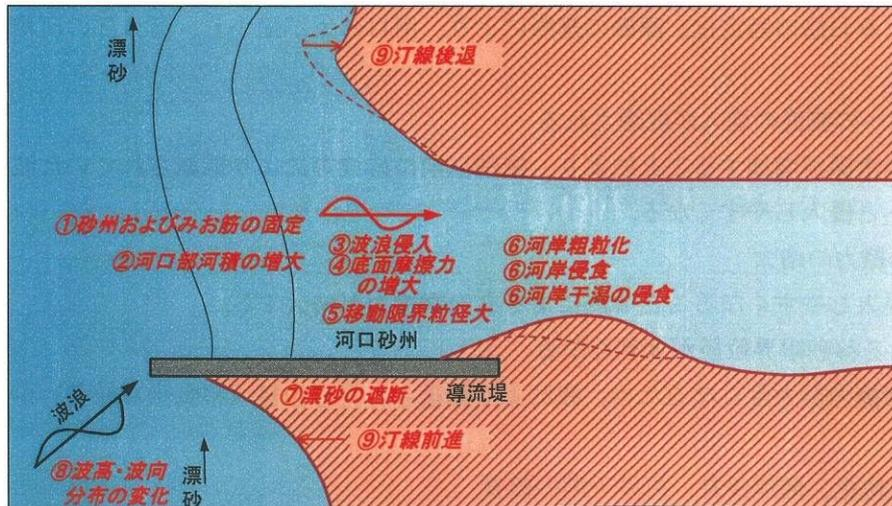
図 4-1-1 河口導流堤の設置イメージ
