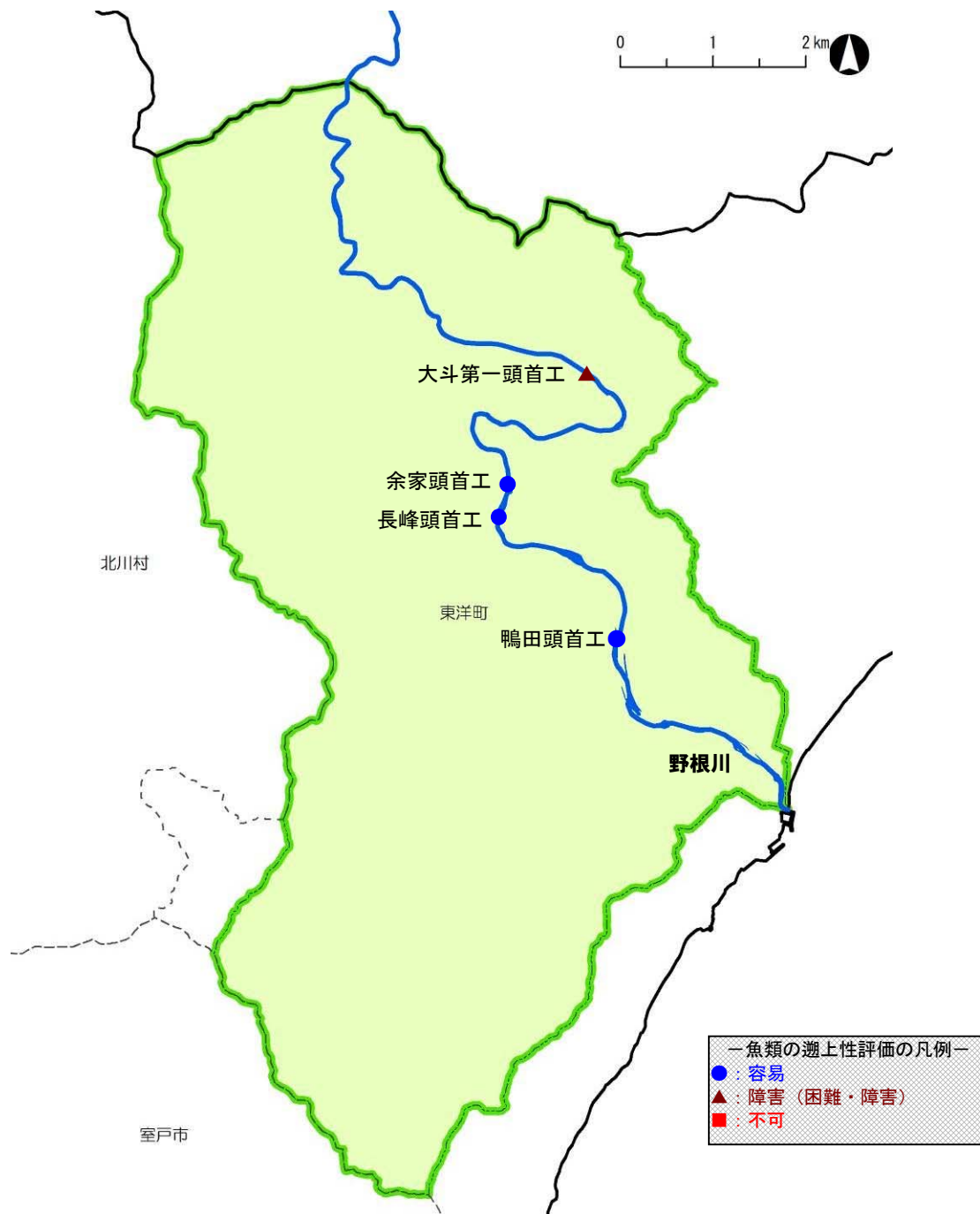
図 3-7-1 確認した横断構造物の位置・名称および魚類の遡上性の評価
