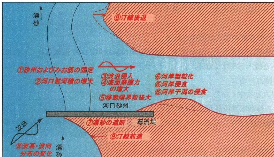
図 4-1-1 河口導流堤の設置イメージ
