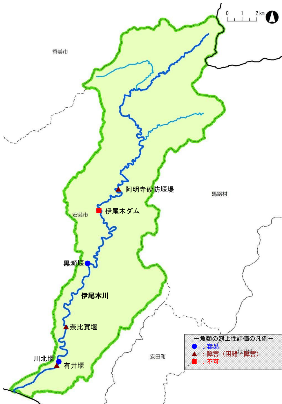
図 3-7-1 確認した横断構造物の位置・名称および魚類の遡上性の評価
