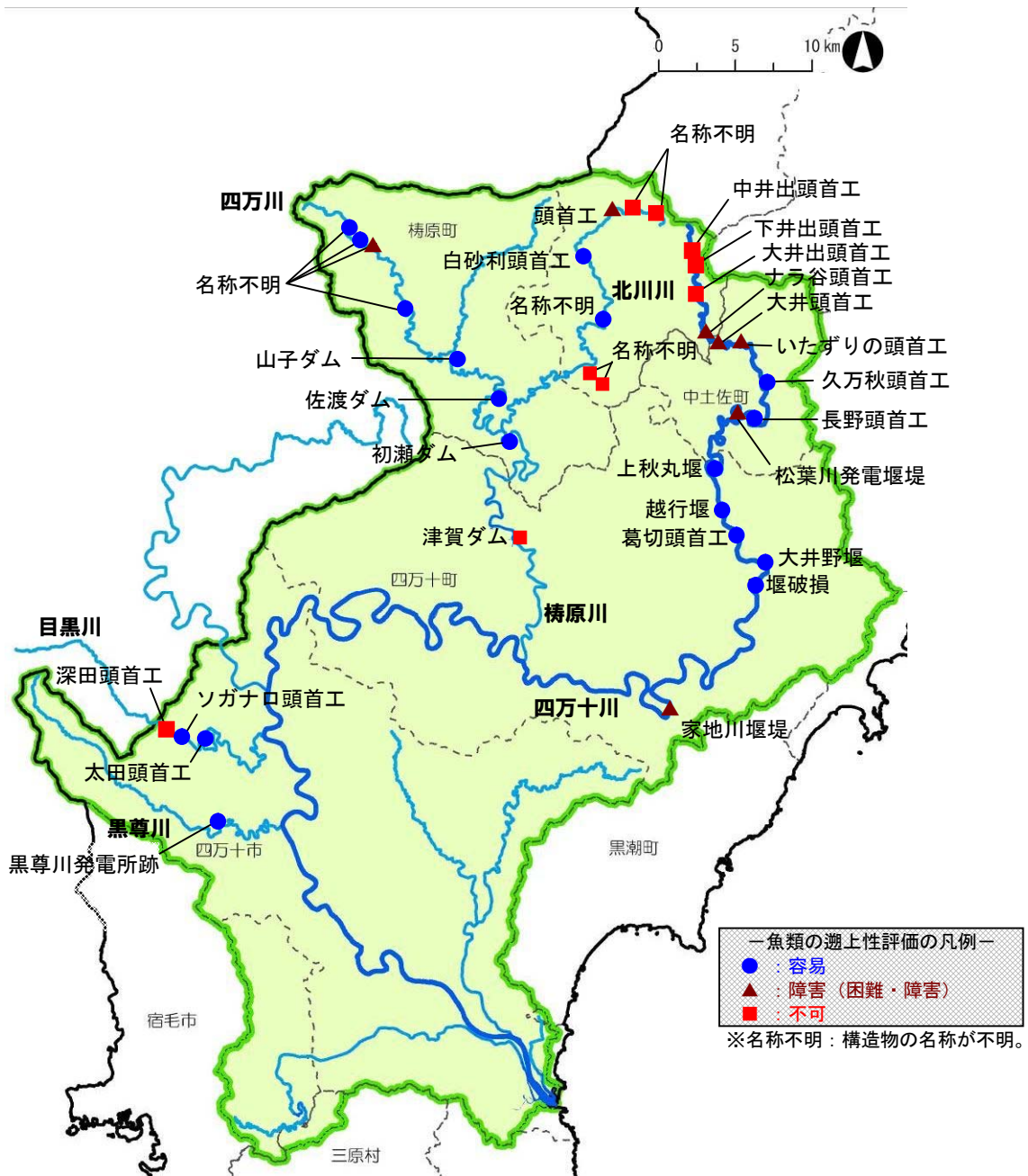
図 3-6-1 確認した横断構造物の位置・名称および魚類の遡上性の評価
