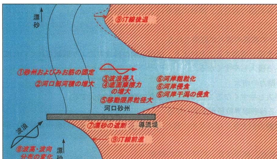
図 4-1-1 河口導流堤の設置イメージ
