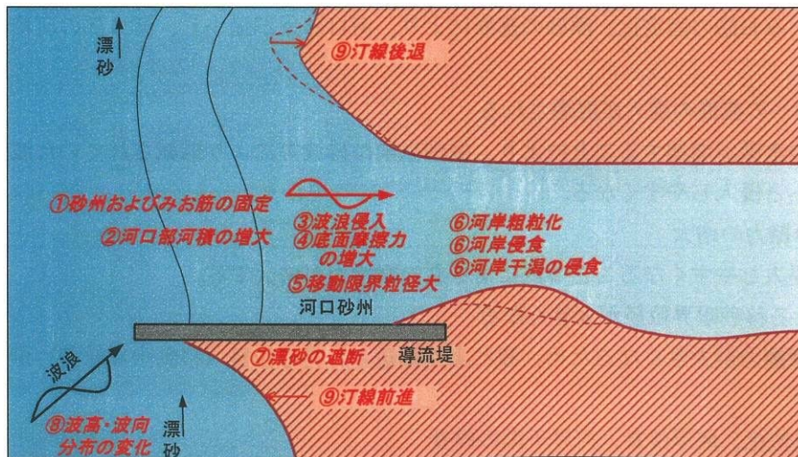
図 4-1-1 河口導流堤の設置イメージ
