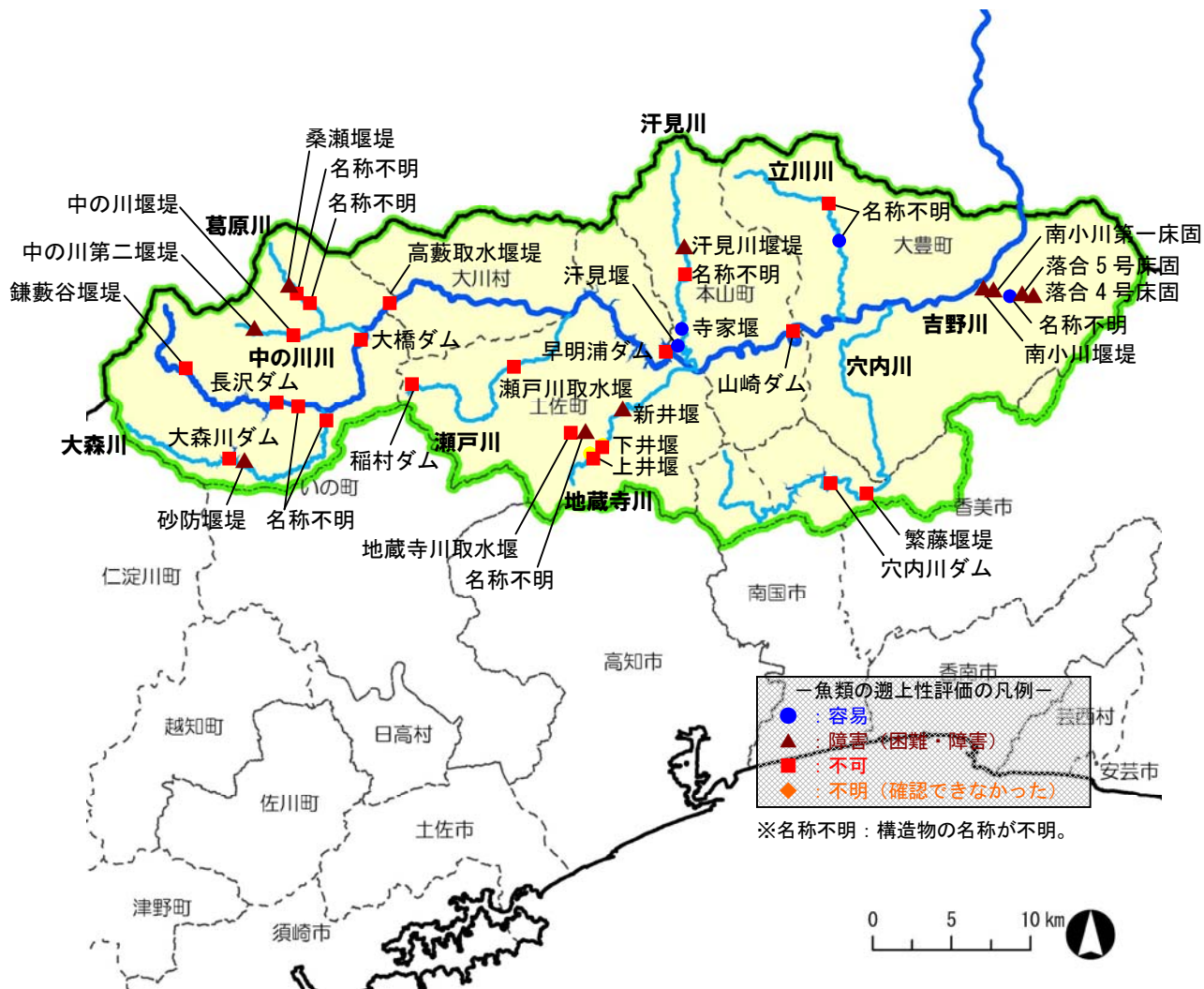
図 3-6-1 確認した横断構造物の位置・名称および魚類の遡上性の評価
