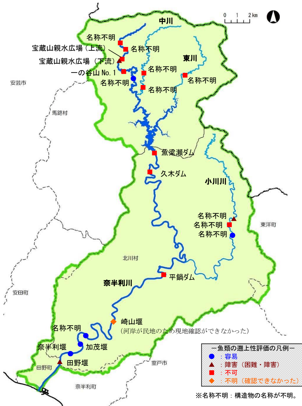
図 3-7-1 確認した横断構造物の位置・名称および魚類の遡上性の評価
