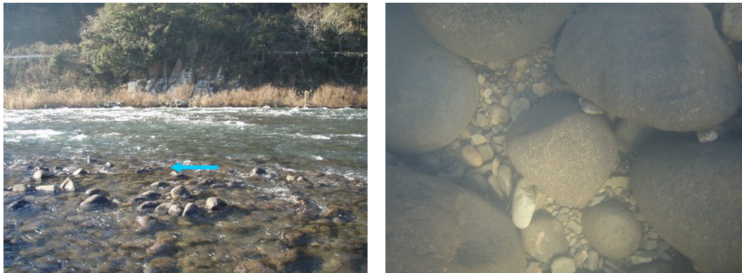
奈半利川の河床石礫の採取場所付近（左）と河床状態（右） 採取場所の水深:0.30~0.40m、採取場所の平均流速:1.2m/s 採取場所の水温:7.6°C、採取場所の濁度:1.4度
